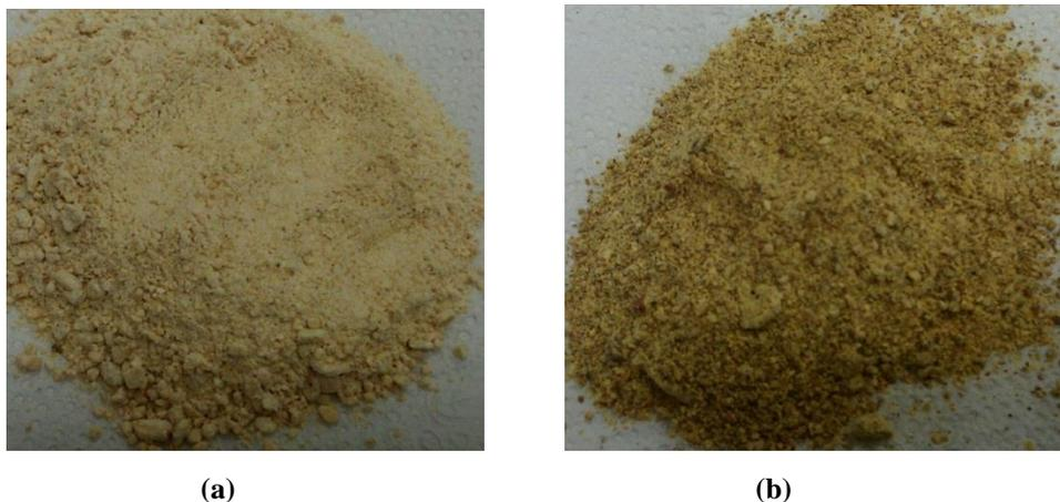
**Figura 2** – Farelo de soja tostado: (a); farelo de nabo forrageiro tostado (b).
